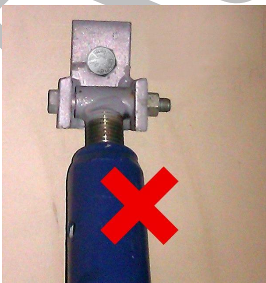
Bild 3. Kan EJ att demonteras, markör/etikett saknas.
